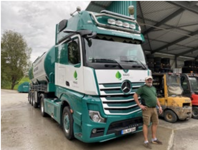
Silozug zum Blasen von Materialien zu schwer zugänglichen Baustellenbereichen, Dirk Ritzler
